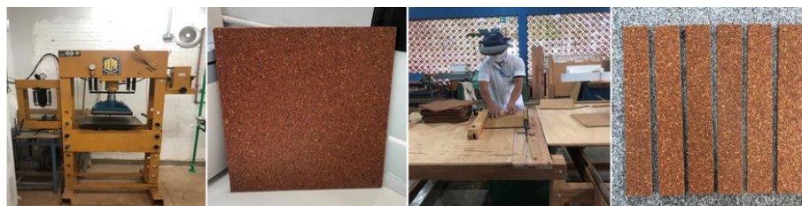
Figura 01 – Processo de confecção e desdobro dos painéis
