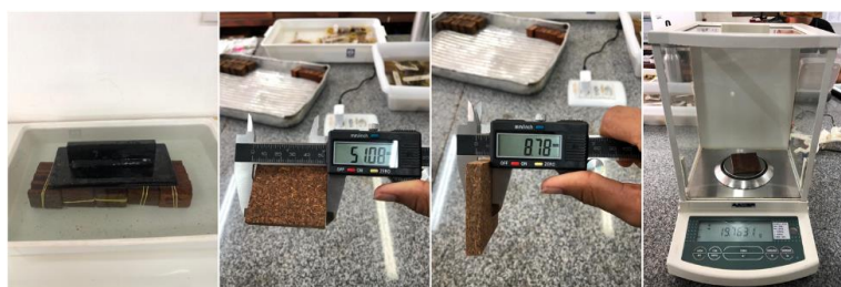
Figura 02 - Avaliação das propriedades de absorção de água e inchamento em espessura
