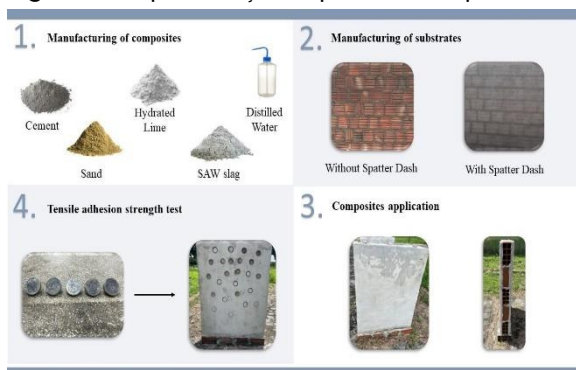
Figura 1 - Representação esquemática do processo de fabricação das amostras.
